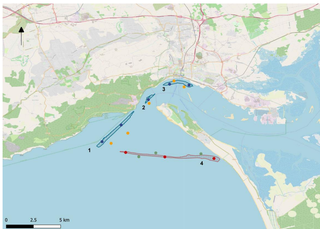
Figura 2 – Mapa com as áreas de dragagem (zonas 1, 2 e 3) e de deposição de dragados (zona 4), com os pontos de amostragem dentro destas zonas e nas respetivas zonas de controlo.
