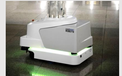
Robot de limpeza – tecnologia UV
