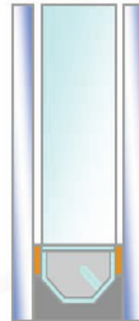
Vidro duplo isolante térmico U_g = 2,8 \text{ a } 3,3 \text{ W/m}^2\text{K}
