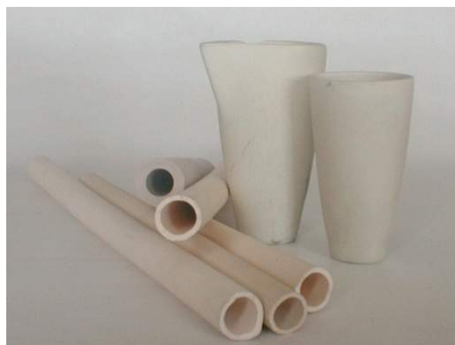
Figure 2: Fired bodies fully processed from the sludge. Corpos cozidos totalmente processados a partir de lamas.
