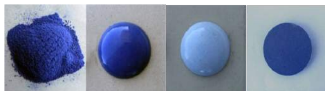
Figure 2: Calcined ceramic pigments and glaze applications. Pigmentos cerâmicos calcinados e aplicações de esmalte.
