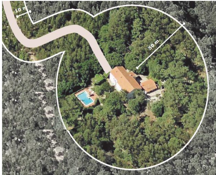
Figura 1 – Faixa de gestão de combustível – Casas isoladas
