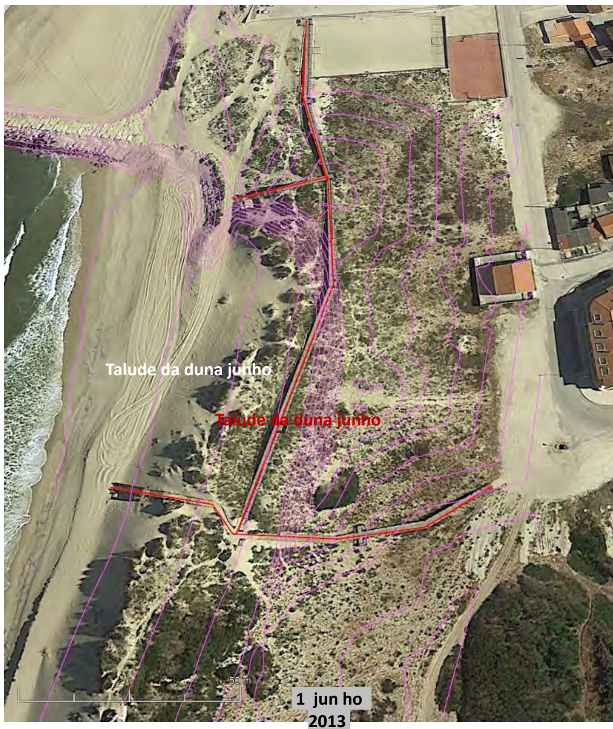
Figura 8. Levantamento de junho de 2018 sobreposto à imagem de junho de 2013 evidenciando o acentuado recuo do que resta do cordão dunar.
