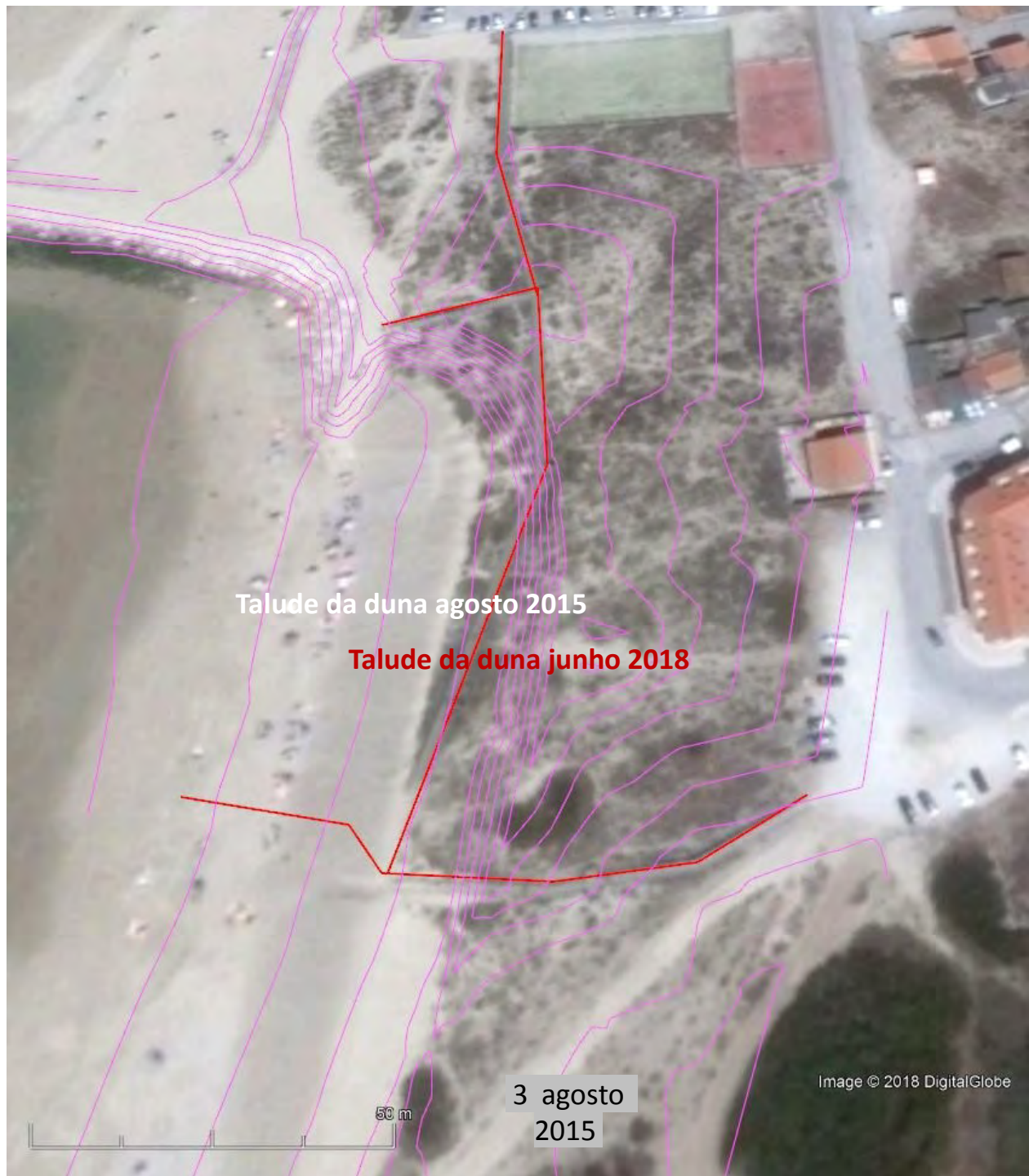
Figura 9. Levantamento de junho de 2018 sobreposto à imagem de agosto de 2015 evidenciando o acentuado recuo do que resta do cordão dunar. A posição inicial dos passadiços de madeira constitui outra evidência desse recuo.
