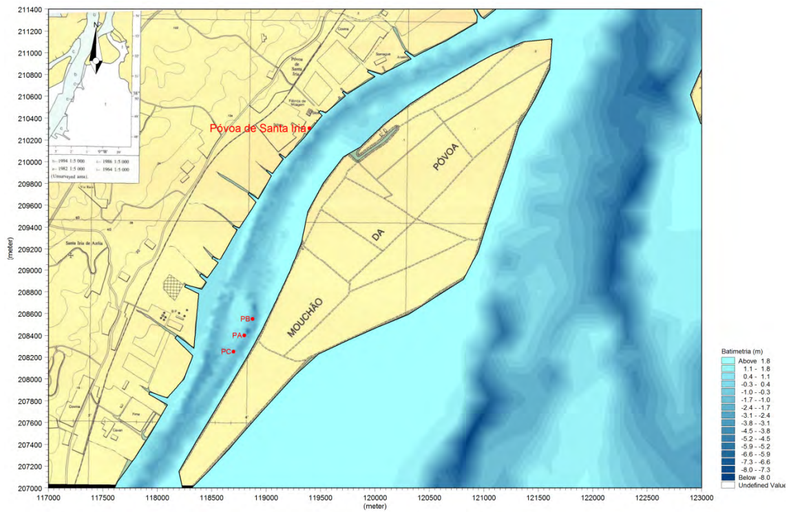
Figura 3.3. – Cenário 1 : Situação inicial. Batimetria na zona de estudo e localização dos pontos onde foram analisadas as velocidades médias da corrente.
