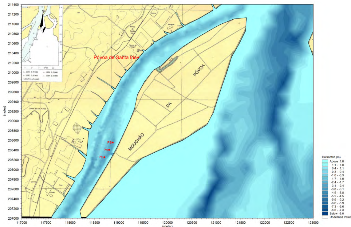
Figura 3.4. – Cenário 2: Situação após reparação do rombo. Batimetria na zona de estudo e localização dos pontos onde foram analisadas as velocidades médias da corrente.
