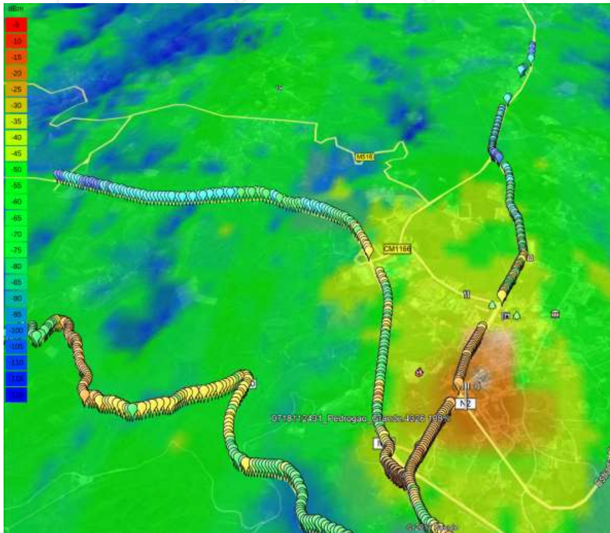
Figura 22 Aferição do modelo de previsão de cobertura, estação base do Pedrogão Grande.
