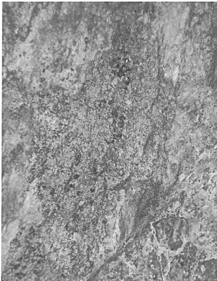
Foto 8 – Filão de quartzo em hasteal de galeria com pequenas pontuações de cassiterite.
