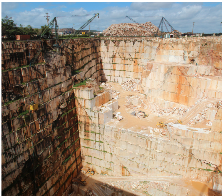
Figura 1 – Cavidade atualmente em exploração por duas empresas que em setembro de 2013 se encontra com oitenta e cinco metros de profundidade. Repare-se como no espaço onde se desenvolve regularmente a atividade extrativa não é possível a fixação de qualquer planta, no entanto nos patamares, ainda que de reduzidas dimensões, dos pisos já explorados é possível ver um coberto vegetal incipiente. Registe-se que no inverno de 2012/2013 a pedreira mais profunda esteve com laboração suspensa e o nível freático subiu até quase atingir o patamar correspondente à pedreira menos profunda. Nas pedreiras ativas são usuais e frequentes os bandos de Pombo-das-rochas ( Columba livia ) que aí encontram condições ótimas para a nidificar em. Fotografia de Luísa Lopes.
