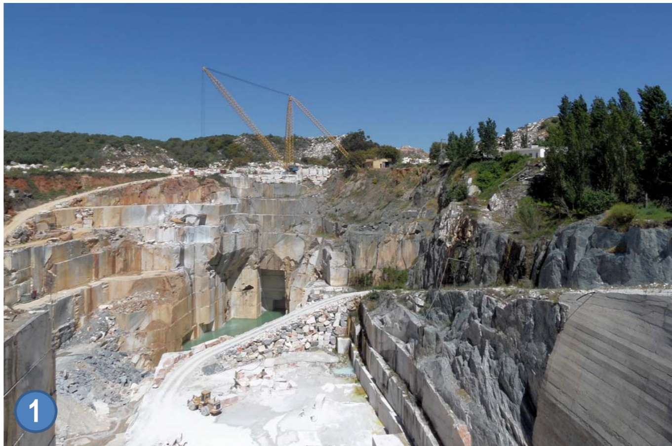
Figura 2: Vista para SE das pedreiras abrangidas pela área em estudo. À direita regista-se o contato entre os mármore e os metavulcanitos básicos, situação que privilegia condições de instabilidade mais frequentes uma vez que, devido à deformação Varisca, os contrastes reológicos entre estas rochas fazem com que os limites sejam verticais. No canto inferior direito da imagem observa-se uma medida de estabilização constituída por um muro em betão armado sobreposto a um sistema de pregagens (não visível na fotografia).
