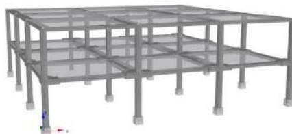
Modelo numérico do bloco tipo da escola no programa SeismoStruct
