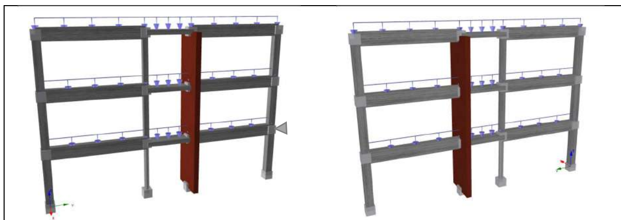
Modelos numéricos dos pórticos transversais do edifício principal no programa SeismoStruct: corpo 1 (esq.); corpo 2 (dir.)
