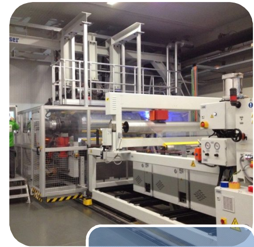
Sistema Calandragem patentado e cross-axis para espessuras baixas
