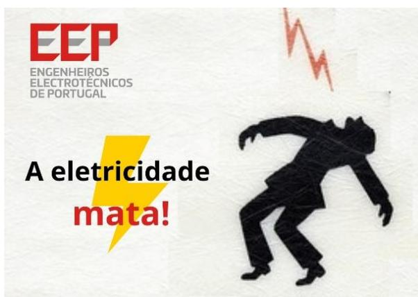
O choque elétrico depende da intensidade da corrente elétrica que atravessa o corpo da pessoa durante o choque e do caminho da corrente elétrica pelo corpo. Não depende da potência elétrica (kVA) da instalação.
