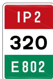
O3b - Demarcação hectométrica da via - IP pertencente à rede de estradas de tráfego internacional
