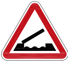
A10 - Ponte móvel
