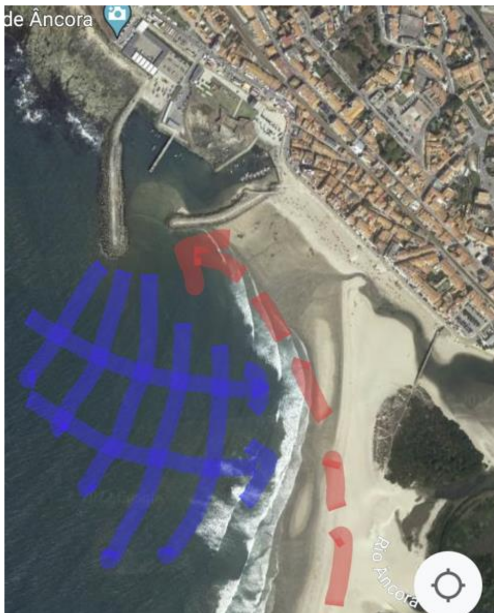
Figura 20 _ Vila Praia de Âncora. Aspecto do principal mecanismo de assoreamento da bacia portuária do Porto de Pesca. Imagem em baixa-mar. A vermelho a corrente local dirigida para norte.
