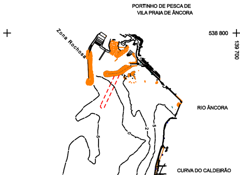
Figura 9 – Proposta de Construção de eventual Obra Fixa de Contenção de Areias com cerca de 250 m de comprimento. Desenho LNEC 2006.
