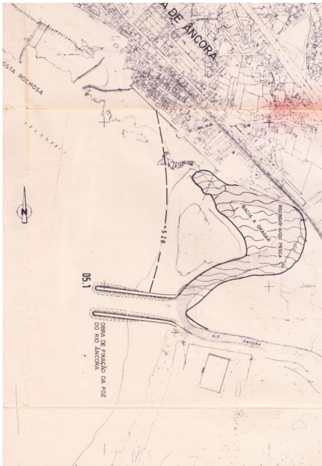
Figura 23 _ Vila Praia de Âncora. Nova embocadura do rio Âncora. Fonte: Desenho 3: Hidrotécnica Portuguesa. Estudo de Problemas Litorais, Troço Embocadura do Rio Minho-Porto de Leixões, Desenho 3 – Plano de Obras. Vila Praia de Âncora. 1988
