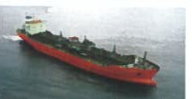
NAVIO DE TRANSPORTE DE ENXOFRE LÍQUIDO 170 m comprimento 28 m boca 21.500 t.d.w.
