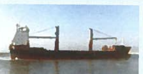
NAVIO PORTA-CONTENTORES 120 m comprimento 20 m boca 9.000 t.d.w.
