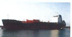
NAVIO DE TRANSPORTE DE PRODUTOS QUÍMICOS 140 m comprimento 23 m boca 19.000 t.d.w.
