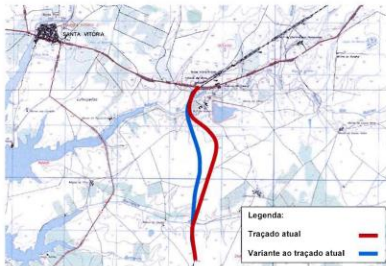
Figura n.º 7 - Linha do Alentejo – Correção do perfil longitudinal entre os km 169+400 e 173+500
