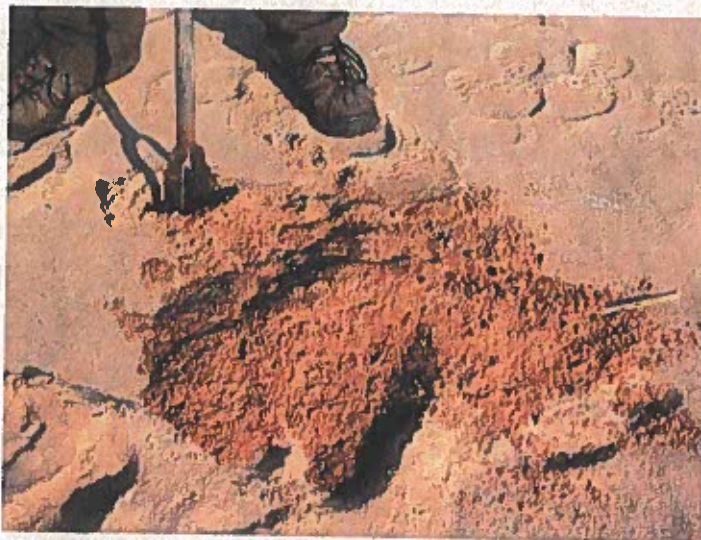
Figura 20 – Diferença de cor e tonalidade entre a areia lavada e a areia argilosa, recolhida com um trado.
