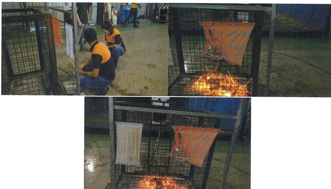
*Figura 6 – No ensaio GO 5, a distância da gola ao cesto foi igualmente de 0.2m. Tratou-se de uma repetição do anterior, tendo-se utilizado, além disso, uma amostra de tecido de algodão colocada ao lado da gola, como se mostra na figura. No final do ensaio a gola estava perfurada, embora não se tenha inflamado, tal como no ensaio anterior. O tecido de algodão, alterou a cor, mas não se deformou nem entrou em combustão.*
