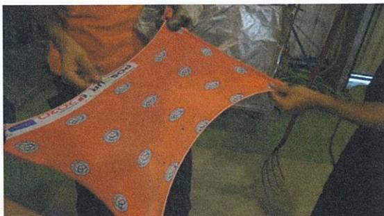
*Figura 7 – Sujeitando a gola ao impacto de partículas incandescentes, verificou-se que esta era perfurada pelas partículas, mas não entrava em combustão.*
